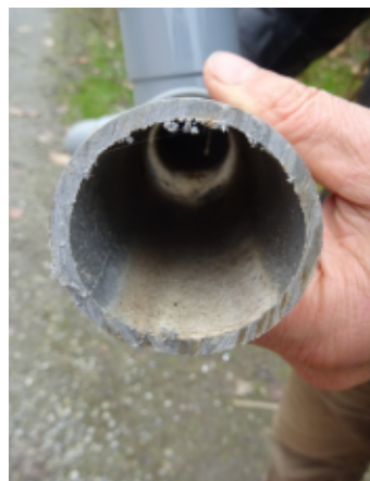
A gauche : canalisation après démontage, entretien des urinoirs sans eau pendant 10 ans
