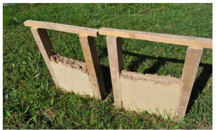
Essai remplissage torchis traditionnel
