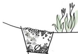
La **tranchée avec évacuation par gravitation** est remplie de **graviers** concassés ou roulés lavés. Un **drain PVC** de type agricole ou un drain rigide peut être ajouté en fond de tranchée. Attention : ne pas ajouter de géotextile qui se colmate dans le temps avec les particules d'argile.
