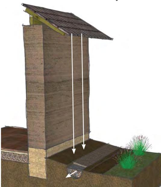
*Principe de drain en chaussette
