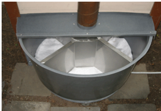
Compartiments du compost et ventilation
