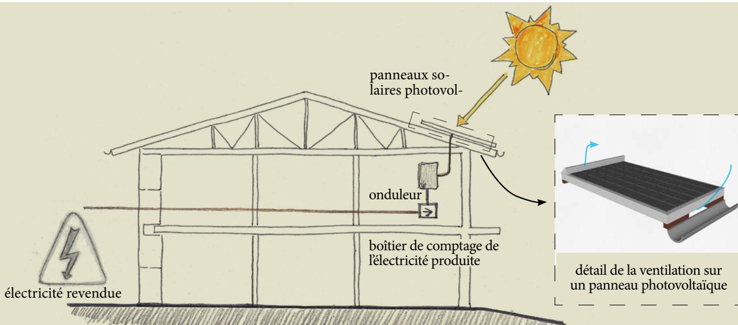
L'installation, qui se trouve sur la toiture du bâtiment, a une puissance de 3kWc. En un an, elle couvre l'équivalent des besoins d'une famille de 4 personnes en électricité (hors chauffage).
